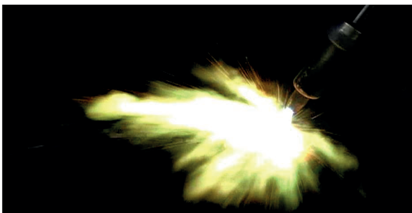
Actual HF 3000 Powder Fusing Process
